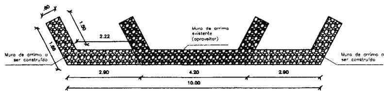
04 Planta de construção do muro de arima
